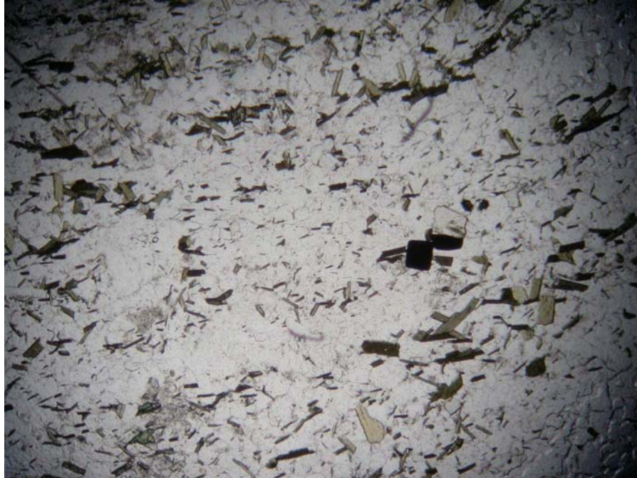
Photo 17 : Mylonite fortement recristallisée associée à un remplacement potassique (microcline et biotite). On note la pyrite cubique (opaque). Échantillon 76890749 (LP, cdv : 2,8 mm).
