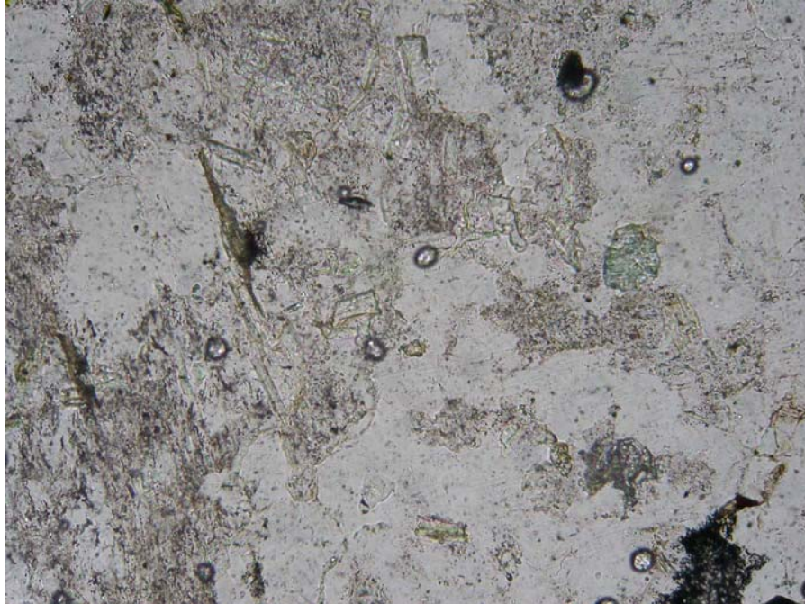
Photo 9 : Vue plus détaillée montrant le remplacement du plagioclase (trouble) par la microcline (claire), échantillon 76890744 (LP, cdv : 0,7 mm).
